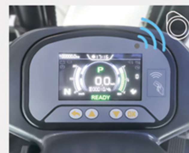
多功能彩屏仪表，智能密码刷卡 Multi-functional color dashboard
